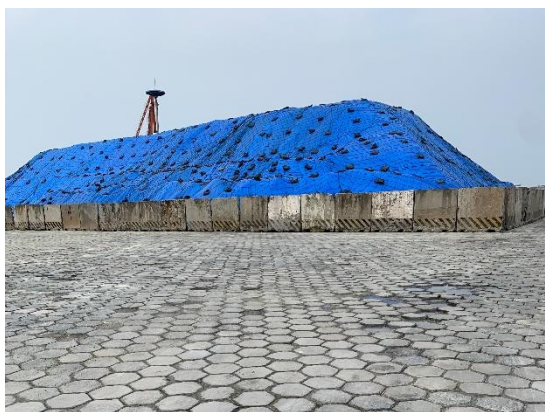
501#硫磺堆垛防雨篷布苫盖
