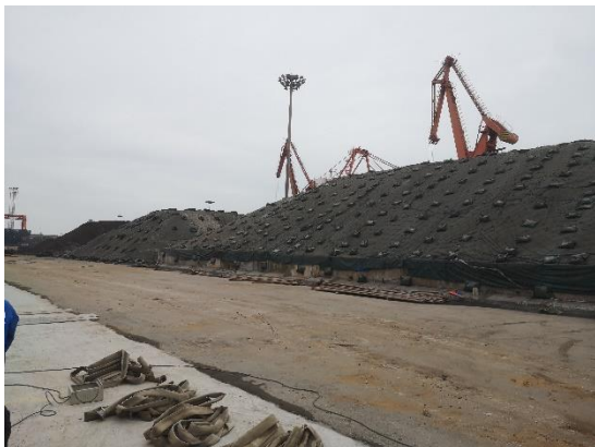
201#化肥堆垛防雨篷布苫盖
